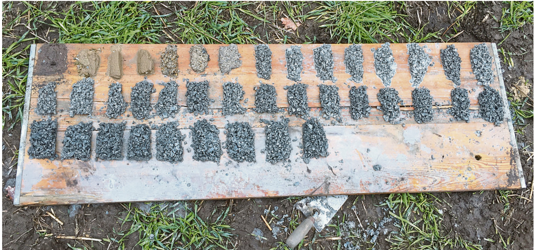
So sieht's aus unter Warendorf: Oben links ist es die ersten paar Meter Mutterboden und Lehm, weiter nach unten rechts kommt dann langsam der Emscher-Mergel. Die ersten Bohrlöcher sind 150 Meter tief.
